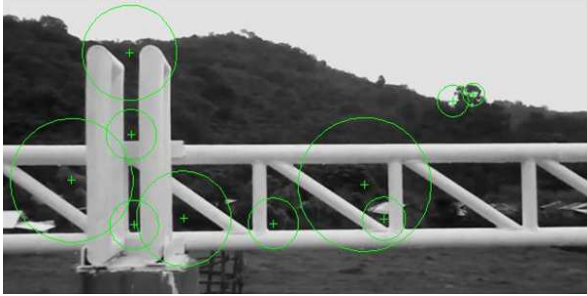
Figura 3: Resultado de la aplicación del método SURF en la imagen captada por el UAV
