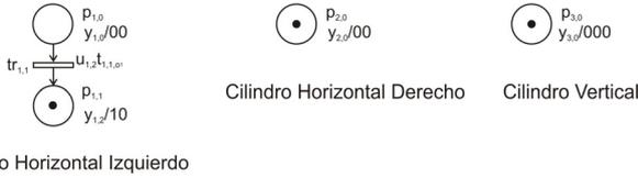
Figura 6: Proceso de modelado del brazo robótico a partir del lenguaje: paso 1
