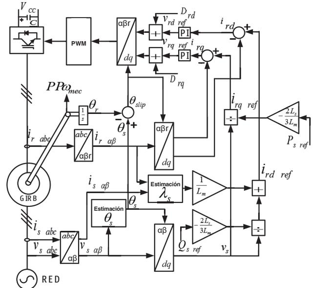
Figura 2: Sistema de control de potencias para el convertidor del lado de rotor del GIRB con uso de controladores PI.
