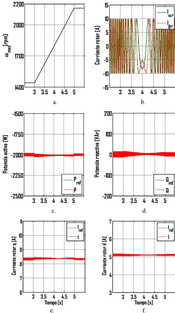
Figura 11: a. Rampa del perfil de velocidad. b. Componentes  $\alpha\beta_r$ , de la corriente del rotor. c. Potencia activa demandada. d. Potencia reactiva demandada. e. Componente q de la corriente del rotor. f. Componente d de la corriente del rotor.
