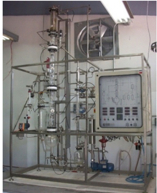
Figura 9: Planta piloto de destilación ubicada en Cenedet.
