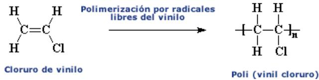
**Figura I.4.** Reacción de polimerización del PVC
