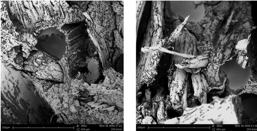
**Figura IV.37.** Microfotografías SEM de superficie de fractura del composite PVC-DINCH. 250 $\mu\text{m}$ . 2 y 4 minutos de exposición UV. (385x y 365x)
