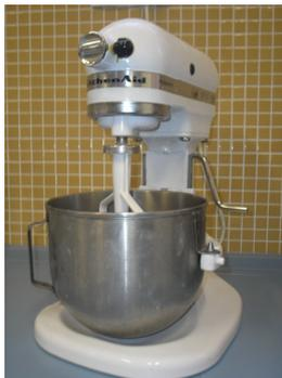
**Figura III.3.** Mezcladora planetaria empleada en la preparación de las pastas de PVC
