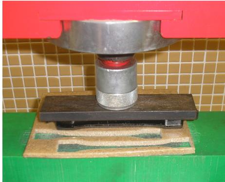
**Figura III.10.** Proceso de troquelado de una plancha de PVC plastificado con cargas celulósicas
