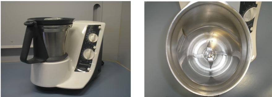
**Figura III.4.** Imagen de la Thermomix (izda.) empleada para la trituración de las virutas de roble y de su cuchilla (dcha.)
