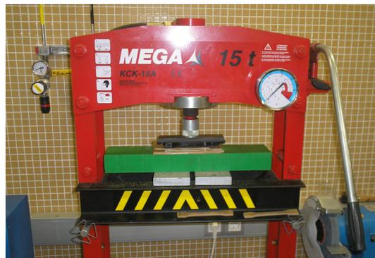
**Figura III.8.** Prensa hidráulica para troquelado de planchas de PVC plastificado con cargas celulósicas
