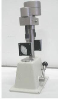
**Figura III.13.** Equipo empleado en la caracterización de la Dureza Shore de plastisoles con cargas celulósicas
