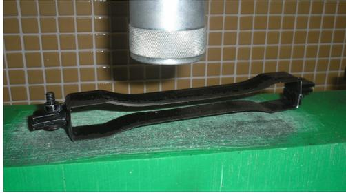
**Figura III.9.** Troquel de corte para obtención de probetas para ensayo de tracción
