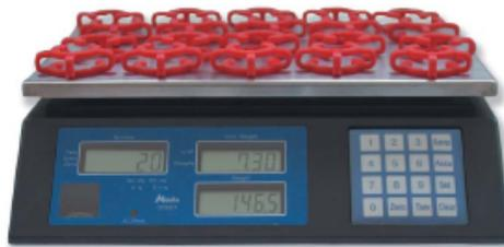
**Figura III.2.** Balanza utilizada para el pesaje de los componentes de las pastas de PVC
