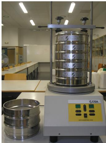
**Figura III.5.** Máquina de tamizado para separación de partículas de roble en diferentes granulometrías
