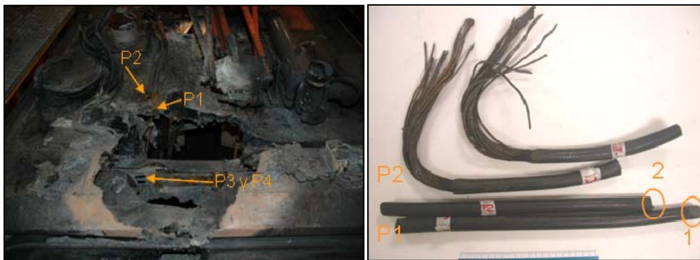
Fig 80. a) Zonas de donde se han tomado las muestras, b) Detalle de algunas de las muestras indicando donde se realizó la preparación metalográfica y la MEB.
