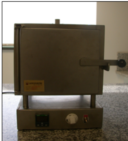
Fig 30. Horno mufla laboratorio docente departamento de mecánica y materiales, temperatura limite de temperatura 1100°C.
