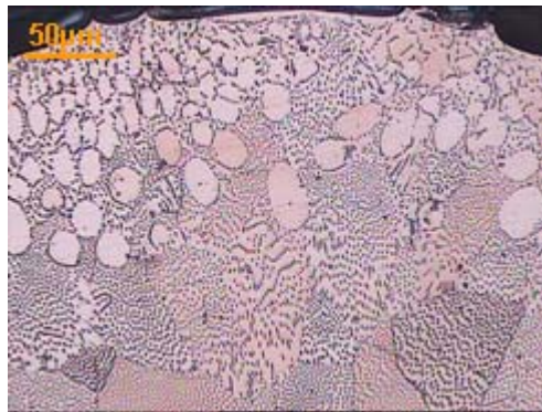
Fig 43. Imagen microscopía óptica de cobre electrolítico de 2,5 mm 2 con tratamiento de 1083°C-45min atacada x200.
