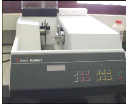
Fig 38. Cortadora automática de precisión de la casa Struers, modelo Accutom 5.
