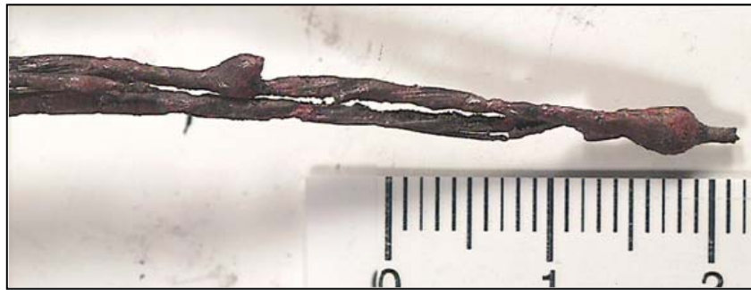
Fig 73. Detalle del extremo de la muestra 4 en el que aparece una perla de fusión con posterior solidificación.
