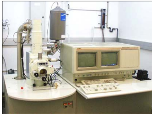
Fig 44. Microscopio electrónico de barrido JEOL JSM 6300, que incorpora el detector de elementos ligeros ISIS Link de la casa Oxford.
