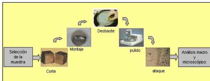
Fig 36. Etapas básicas de la preparación metalográfica
