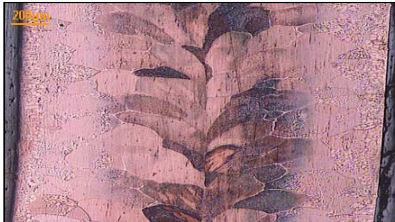
Fig 69. Montaje de toda la sección del conductor de sección 4 mm 2 a temperatura 1083°C y 45 min en el horno x 50. Montaje de la abundante formación de eutéctico en los bordes y la sodificación de los conductores
