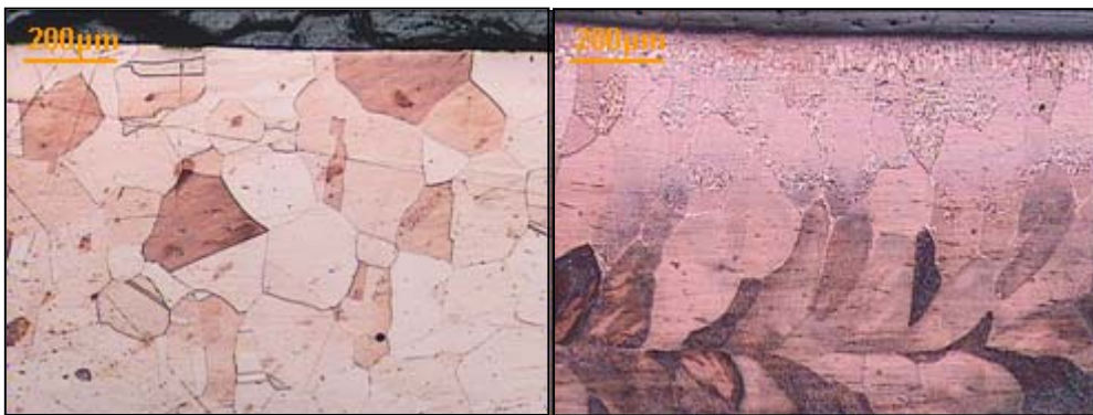
Fig 61. Microestructura de conductor 4mm 2 con un tratamiento de 1050°C y 1083°C respectivamente, durante 45 min, y enfriamiento al aire.
