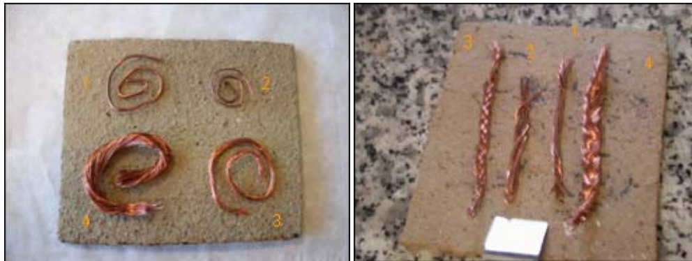
Fig 29. Muestras preparadas para la observación de los efectos del calor en los conductores de cobre.
