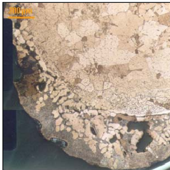
Fig 102. Secuencias fotográficas de: a) , b) corte transversal y , c) y d) corte longitudinal, de la muestra 1, en los que se aprecia un fuerte engrosamiento de grano y una oxidación importante a través del borde de grano, junto a la aparición de abundante porosidad debido a la difusión de gases por las elevadas temperaturas. 50X.
