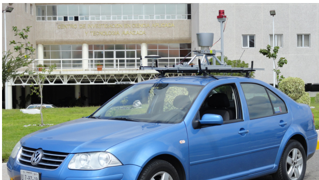
Figura 1: Sistema de Reconstrucción 3D. Nuestro sistema se encuentra montado en un vehículo, para realizar el levantamiento de los datos circulares en áreas urbanas. La LadyBug cuenta con seis cámaras que capturan la escena en sus 360°, el GPS obtiene la posición en longitud y latitud del área en la que circulamos y el LIDAR reconstruye los 360° de la escena.
