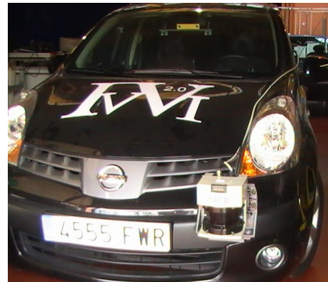
Figura 3. Plataforma IVVI 2.0 con el escáner láser montado en el paragolpes delantero y la cámara en el parabrisas.
