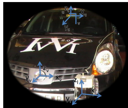
Figura 8. Diferentes sistemas de coordenadas en el vehículo. (x_c, y_c, z_c) es el sistema de coordenadas de la cámara, (x_i, y_i, z_i) es el sistema de coordenadas del láser, y (x_v, y_v, z_v) es el sistema de coordenadas. Las coordenadas (u, v) son las coordenadas de la imagen.
