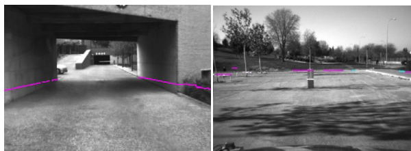
Figura 9. Ejemplo de dos patrones empleados para la calibración on-line. Los parámetros extrínsecos se van modificando hasta casar los datos del láser con la imagen.
