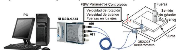
Figura 1: Instalación experimental.
