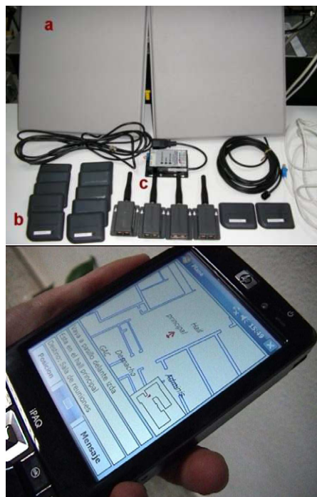
Figura 2: Parte superior: sistema RFID adquirido a la empresa Wavetrend: (a) antenas de tipo panel (direccionales); (b) marcadores (tags) activos; (c) antenas omnidireccionales con lector. Parte inferior: PDA iPAQ de HP con el sistema de localización basado en RFID en funcionamiento.
