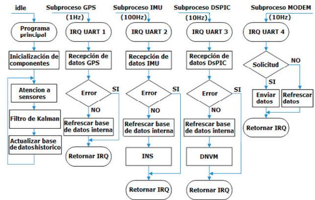
Figura 6: Hilos del software de la unidad PC-104
