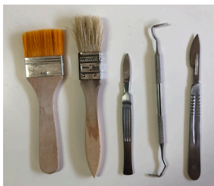
Figura 49. Materiales susceptibles de ser empleados para realizar la limpieza mecánica. De izquierda a derecha, brocha de cerda sintética, brocha de cerca natural, escalpelo, sonda de dentista y bisturí.
