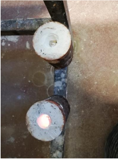
Fig. 28. Cilindros con metal fundido. Proceso de enfriamiento.
