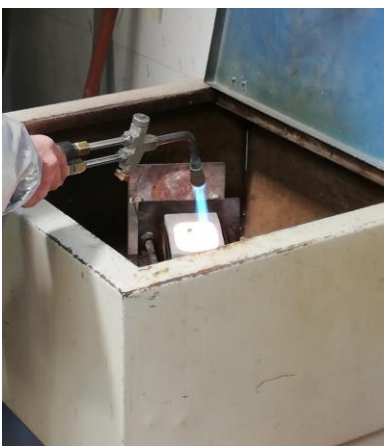
Fig. 27. Fusión del metal en el crisol con soplete.
