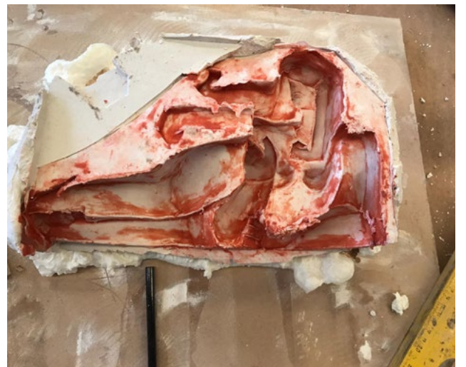
Fig. 94. Molde en silicona y contramolde en escayola antes de ser positivado.
