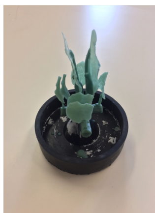
Figs. 43, 44, 45, y 46. Irene Egiazarian Bznuní: Molde de silicona, piezas en cera, construcción del árbol de colada, 2018.
