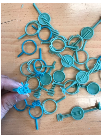
Figs. 31 y 32. Irene Egiazarian Bznuní. Proceso técnico de Inyección de ceras, 2018.
