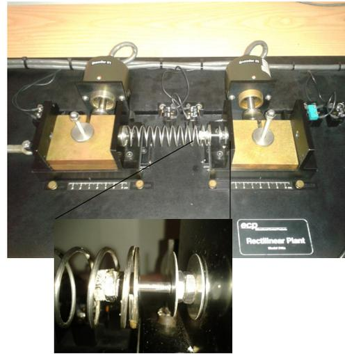
Figura 4: Plataforma experimental ECP-210 modificada para tener una holgura elástica
