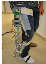
Figura 1: Exoesqueleto de dos grados de libertad para asistir la pierna derecha.
