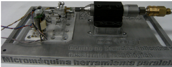
Figura 9: Prototipo de micromáquina herramienta paralela.
