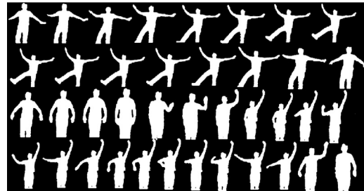
Figura 2: Siluetas obtenidas del procesamiento de mapas de profundidad.
