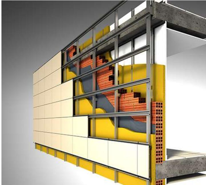
*Figura 8. Construcción de fachada invertida ventilada con paneles ligeros*
