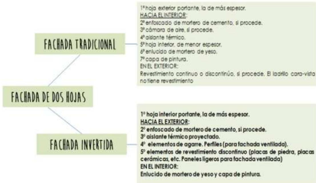
Tabla 3. Esquema de construcción de fachada tradicional e invertida
