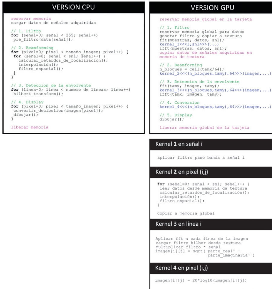
Figura 4: Algoritmo computacional en pseudocódigo. Implementación CPU (izquierda), GPU (derecha) y descripción general de los kernels diseñados para cubrir las distintas etapas del algoritmo (abajo)
