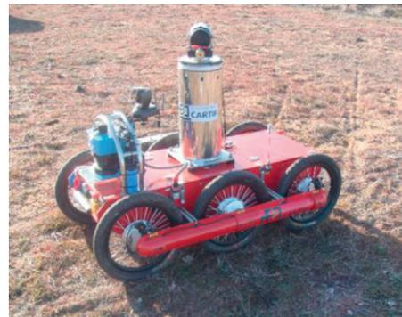
Figura 1: Robot Todoterreno con el sistema de medición tridimensional embarcado.
