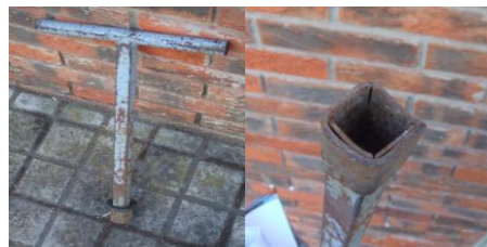
Imagen 42. Llave para abrir el paso del agua.
