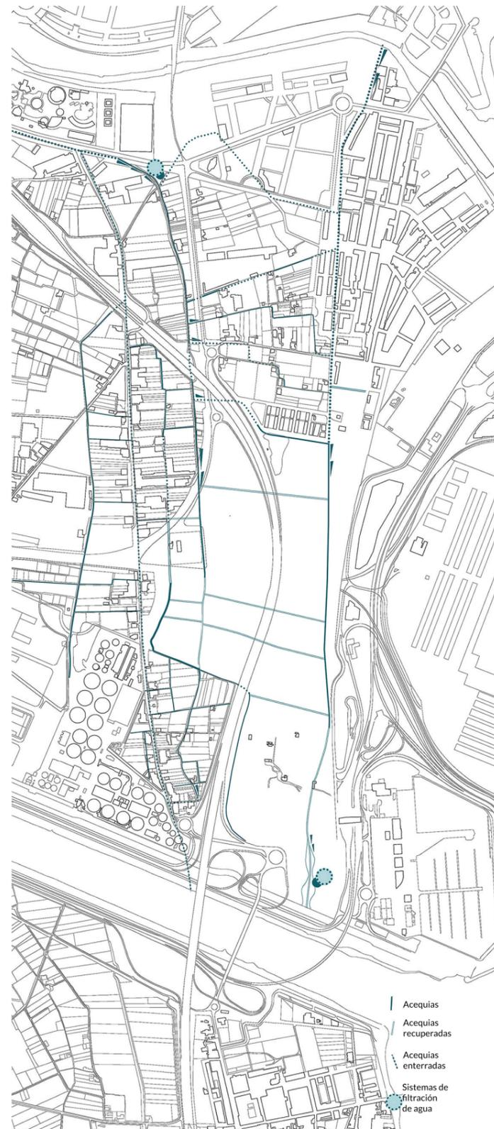
La estrategia de actuación parte de la **reconexión de los ejes vertebradores** y la recuperación de **elementos comunitarios y de paisaje diferenciadores** de la zona. Para comenzar con la reconexión, se soterra el tren y se abren túneles peatonales bajo la carretera elevada, siguiendo el trazado de las antiguas acequias. Esto permite recuperar la red de acequias, como tejido de conexión básico en los poblados de huerta.
