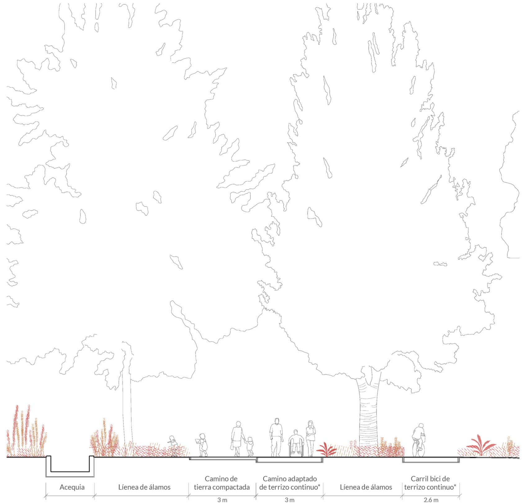
\*En las zonas donde coinciden con el asfalto preexistente, los caminos adaptados y de carril bici, se hacen manteniendo el asfalto
