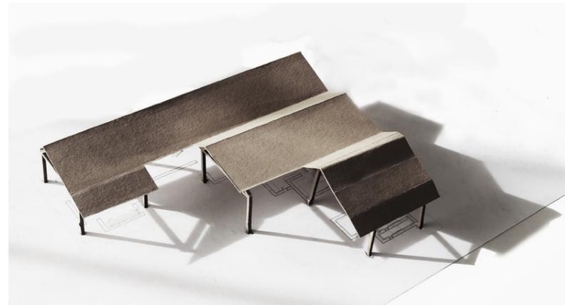
Los espacios servidores se construyen como “cajas” de paja y madera (técnica CUT), que permiten la circulación de aire sobre su forjado, mientras se protegen de la lluvia y el sol por la cubierta superior.
