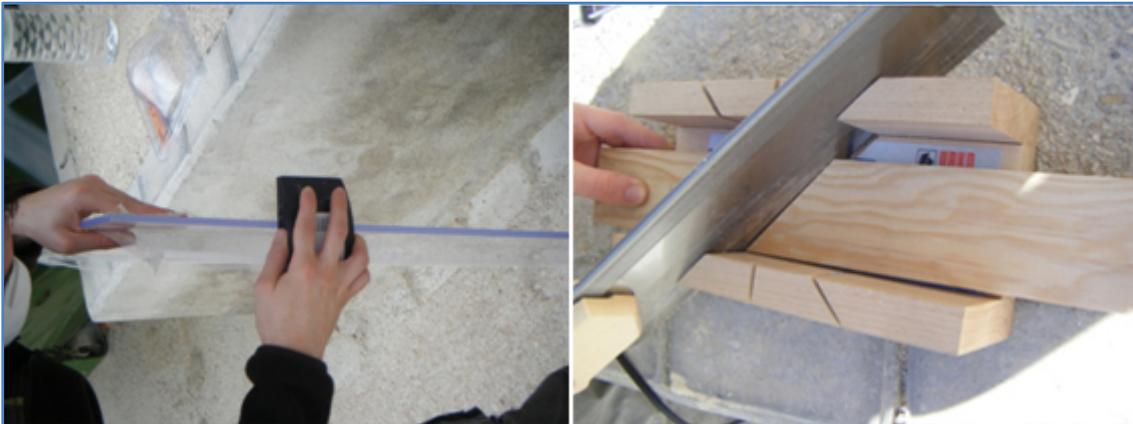
Figura 16: Izquierda. Lijado del perfil del acrílico. Derecha. Creación del marco de madera.
