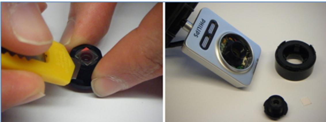
Figura 20: Retirada del filtro infrarrojo.
