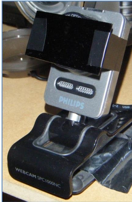
Figura 21: Filtro paso alto de 850nm montado.
