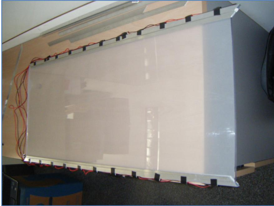
Figura 18: Cableado y leds infrarrojos ubicados a los dos lados del acrílico.
