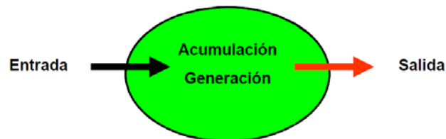
Figura 1. Representación de los términos de la ecuación general de los balances en un sistema
