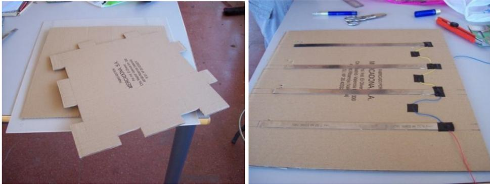
Primer ensayo. Módulo de carton y captores de flejes de acero
