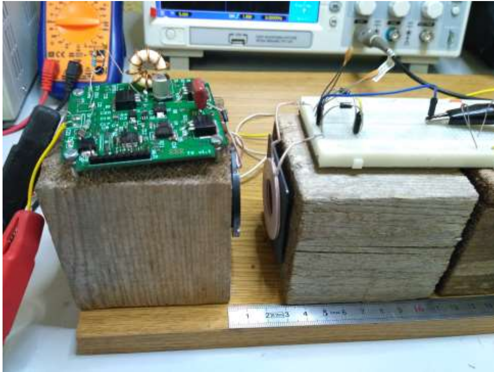
Ilustración 61: Montaje para las medidas de transferencia de potencia
