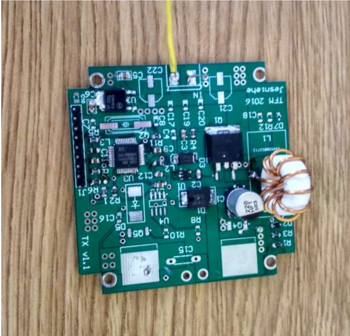
Ilustración 57: Montaje de la BUCK en la PCB
