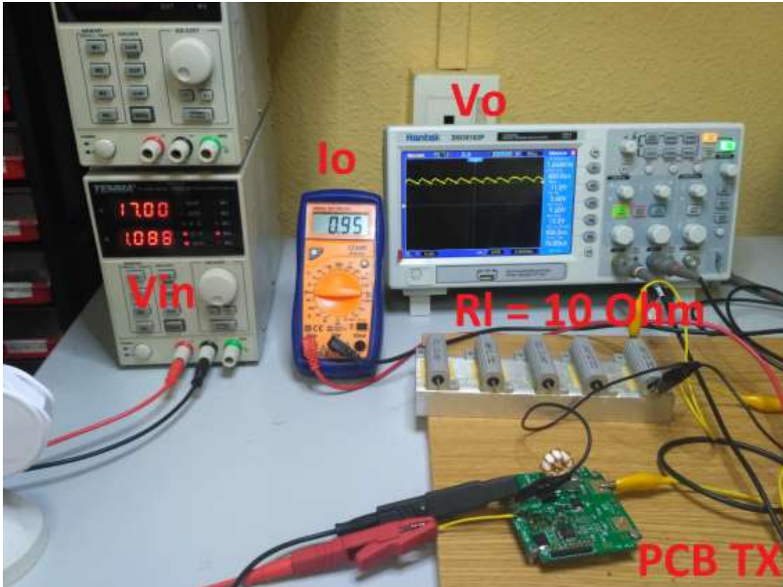
Ilustración 55: Vista general del ensayo de la BUCK
