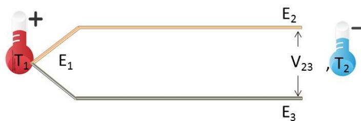
Figura 3. Representación de una unión bimetálica o par metálico. La unión se expone a una temperatura mayor que la del lazo abierto.
