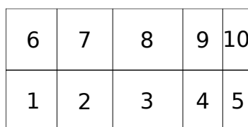
(a) Mallado estructurado en un dominio bidimensional. Los números indican el número de celda.
