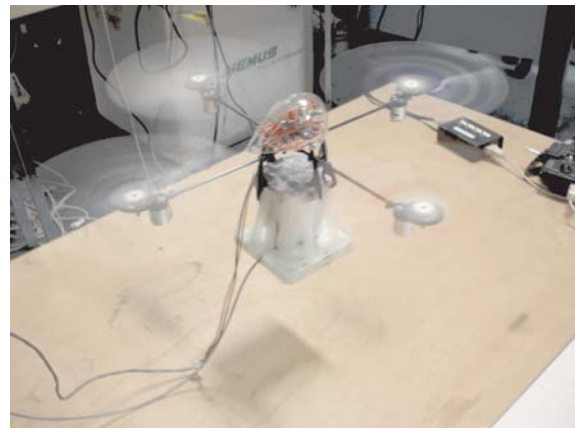
Figura 13. Vuelo estacionario autónomo del quadri-motor. Los cables en el helicóptero que se ven en la figura son de la alimentación eléctrica de los motores y del sensor electromagnético.
