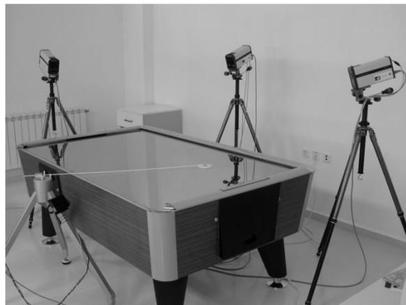
Figura 8. Robot flexible de un grado de libertad construido con material compuesto y apoyado sobre una mesa de aire
