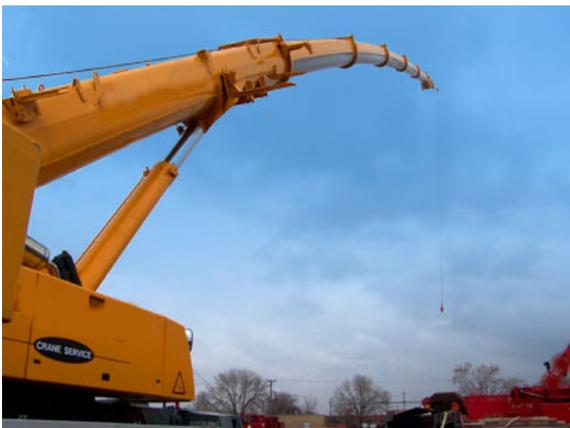
Figura 4. Deflexión estática producida en una grúa de grandes dimensiones como consecuencia de la carga transportada
