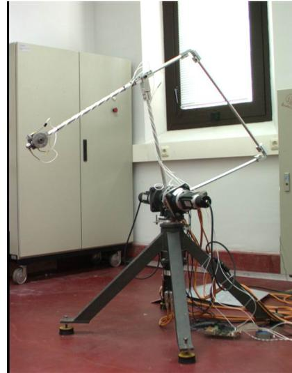
Figura 5. Robot flexible de tres grados de libertad
