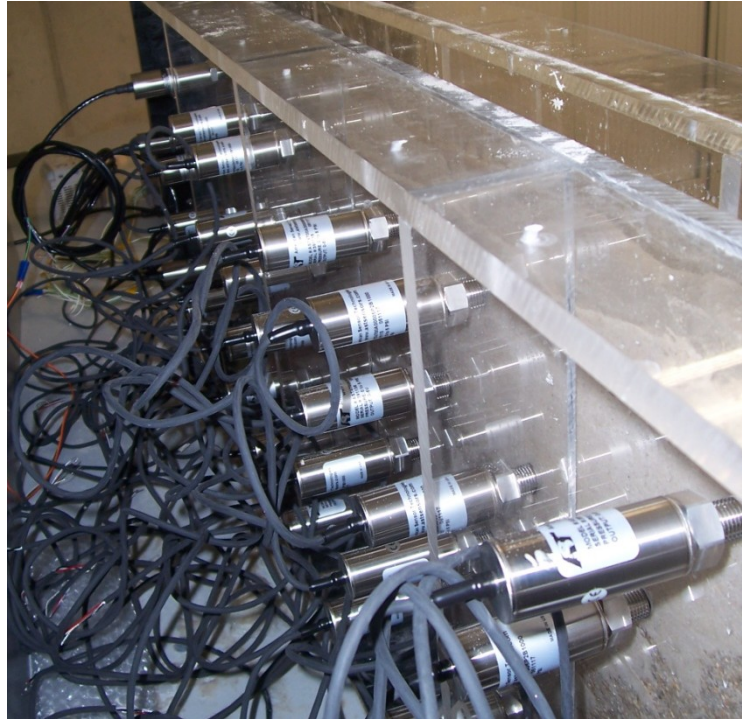
Figura A.14 – Colocación de los sensores de presión a través de la pared del tanque
