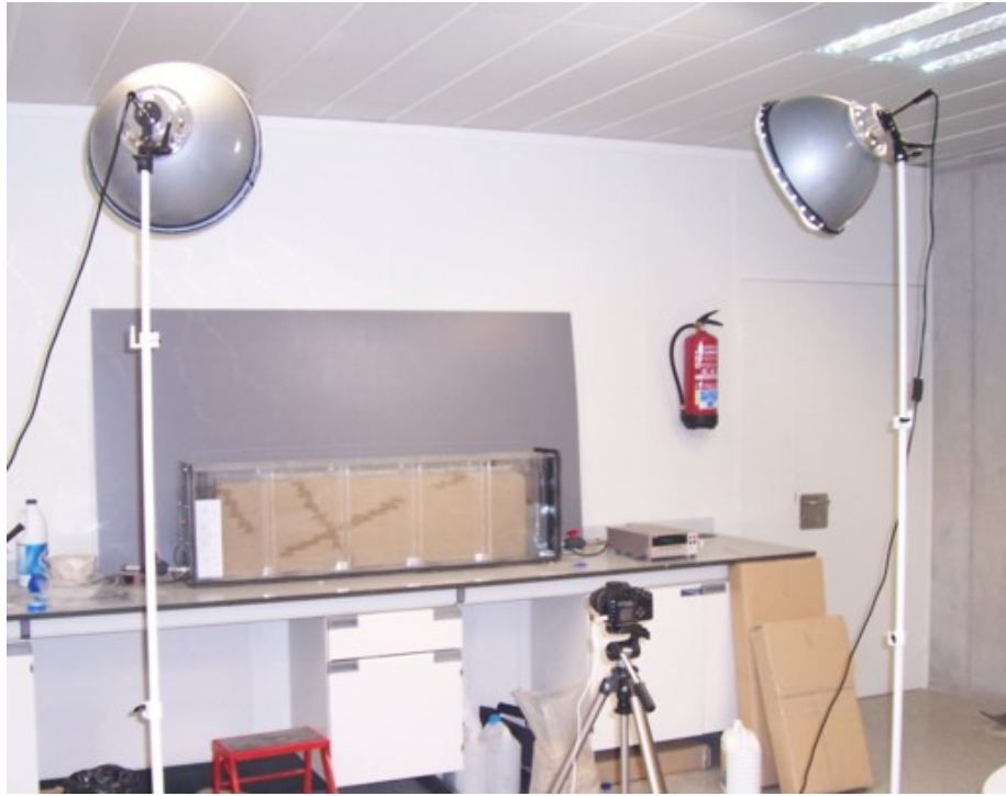
Figura 3.-3.11 – Montaje del sistema de imagen digital destinado a la estimación de concentraciones en el medio
