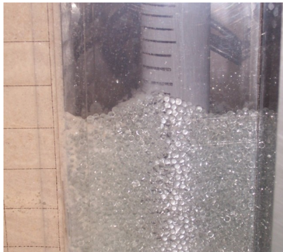
Figura A.9 - Detalle del relleno de perlas de vidrio en la cámara de entrada
