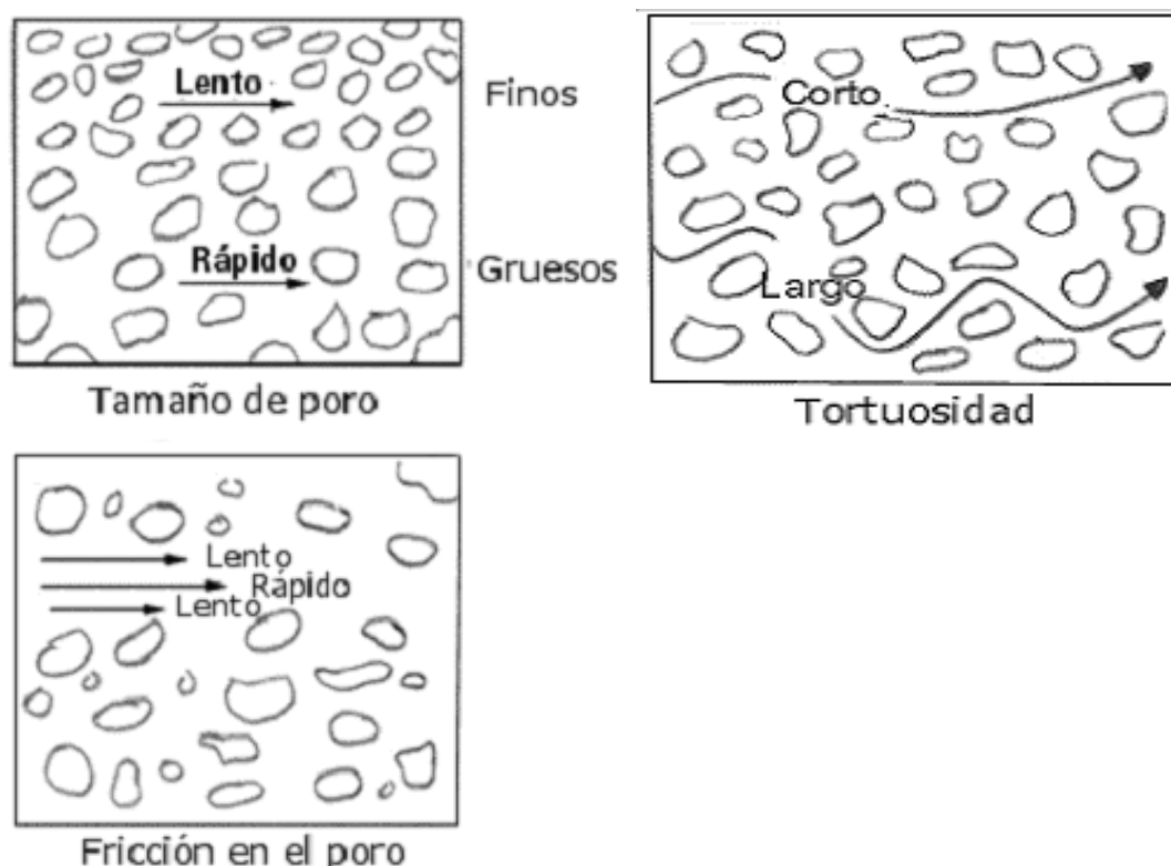
Figura 2.4 – Factores que causan la dispersión longitudinal a escala de poro (Fuente: Freeze y Cherry, 1993)
