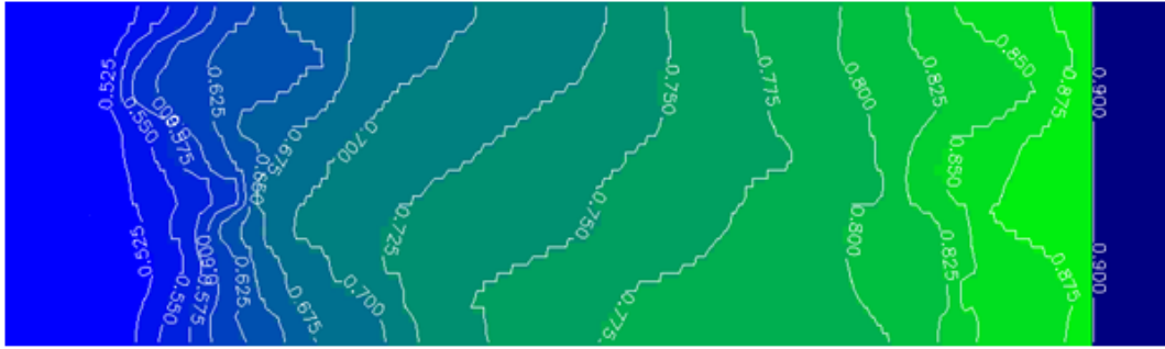
Figura 3.23 Mapa de alturas piezométricas del modelo numérico (en cm)
