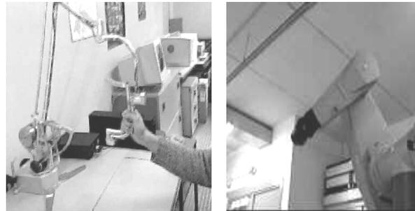
Figura 7. A la izquierda, el dispositivo Cyberforce, en Roma, Italia (sitio local) y a la derecha, el robot PUMA, en Verona, Italia (sitio remoto).
