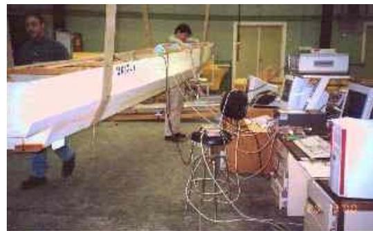
Fig. 2. Ensamblaje del modelo a escala para experimentación de un ferry rápido.
