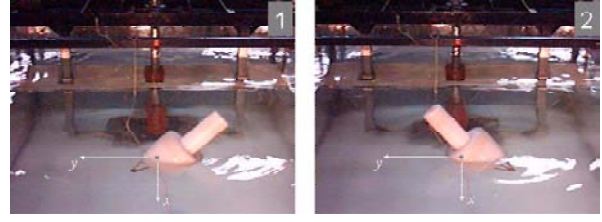
Fig. 8. Inestabilidad cinemática de período doble con órbita transversal a la ola en una boya a escala
