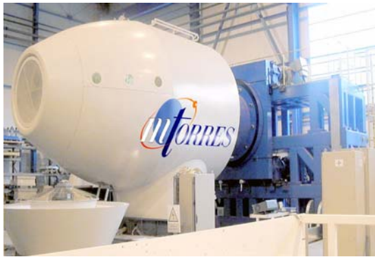
Fig. 8. Banco de Ensayos para Aerogeneradores de hasta 3 MW de potencia (Cortesía de M.Torres).
