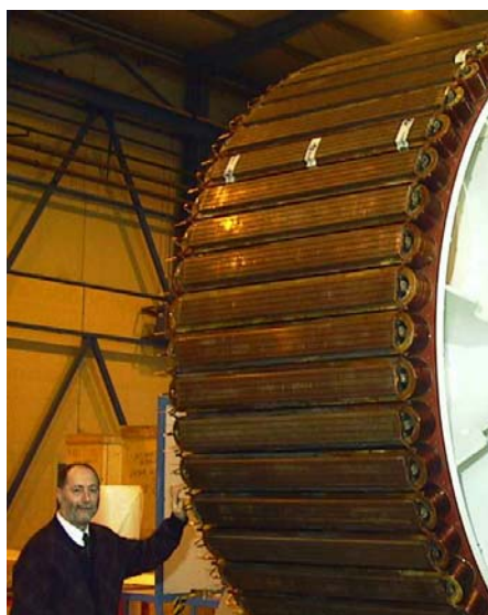
Fig. 6. Rotor del generador síncrono multipolar (Cortesía de M.Torres)
