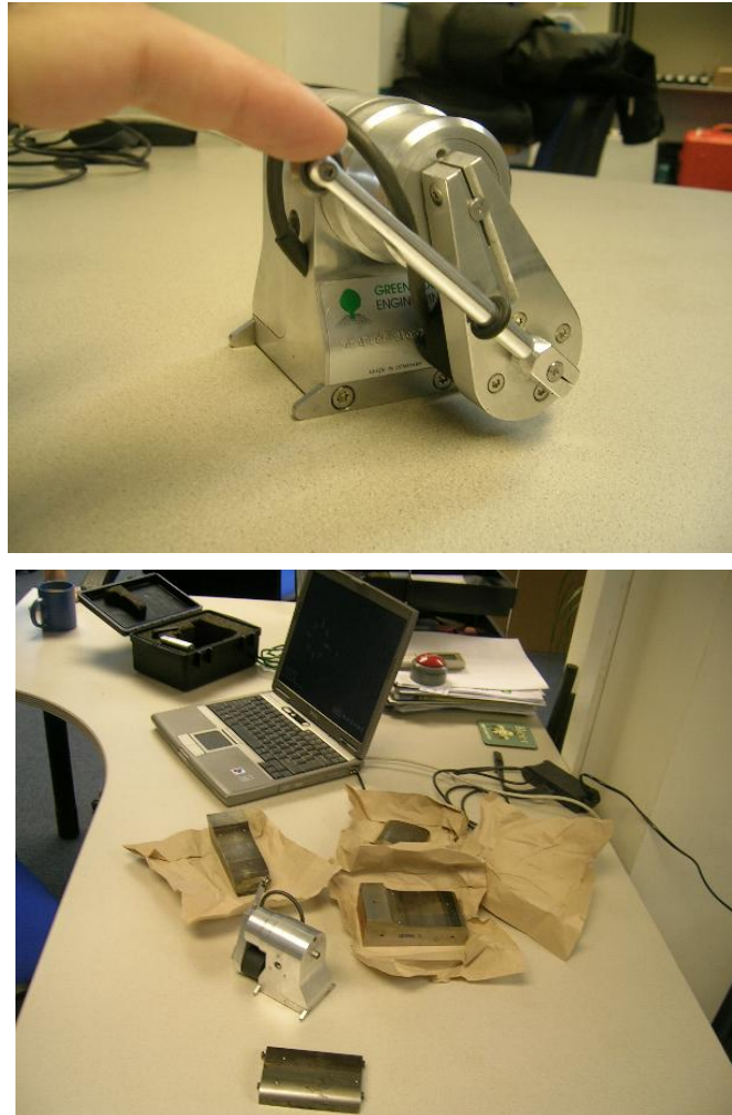
Figura 4.43. Izq: dispositivo Miniprof. Dcha.: especímenes cuyos perfiles transversales se han escaneado.
