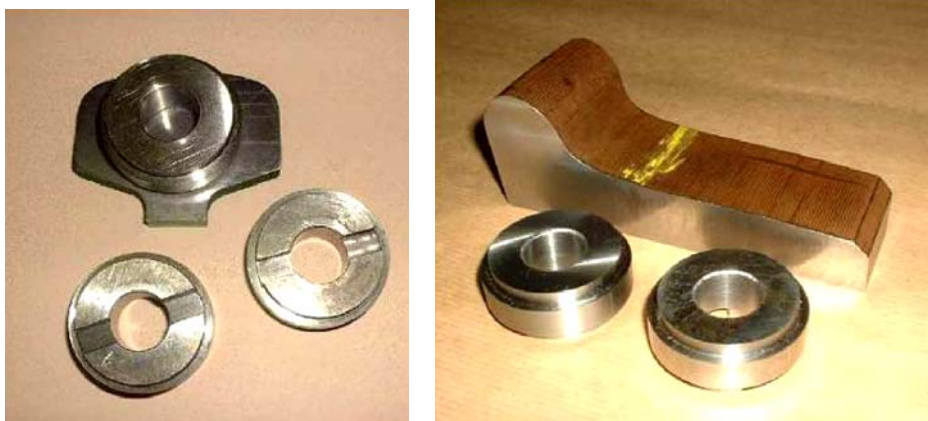
Figura 5.23. Obtención de los especímenes para la máquina SUROS a partir del carril y de la rueda. Extraído de [30].
