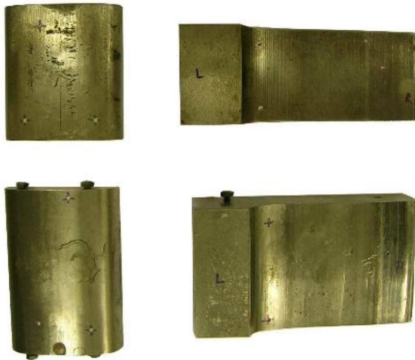
Figura 4.42. Especímenes de rueda y carril correspondientes a perfiles nuevos (arriba) y perfiles desgastados (abajo).
