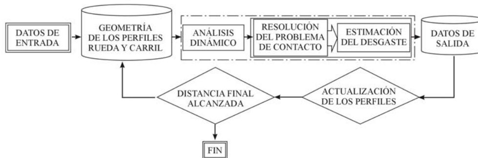
Figura 6.1. Diagrama de flujo de la herramienta de predicción de desgaste implementada. Adaptado de [86].
