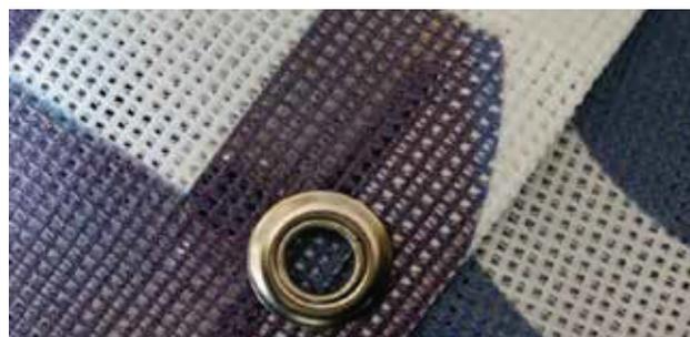
Figura 18. Lona microperforada
