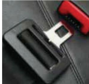
Figura 135. Hebilla cinturón de seguridad
