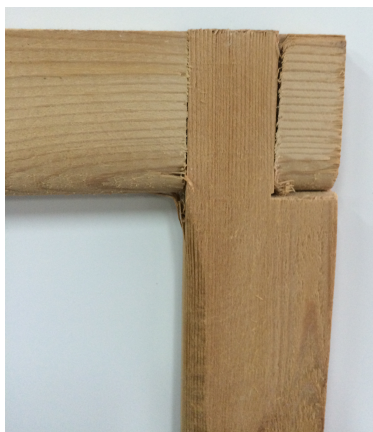
FIG. 16. Detalle ensamble del bastidor.
