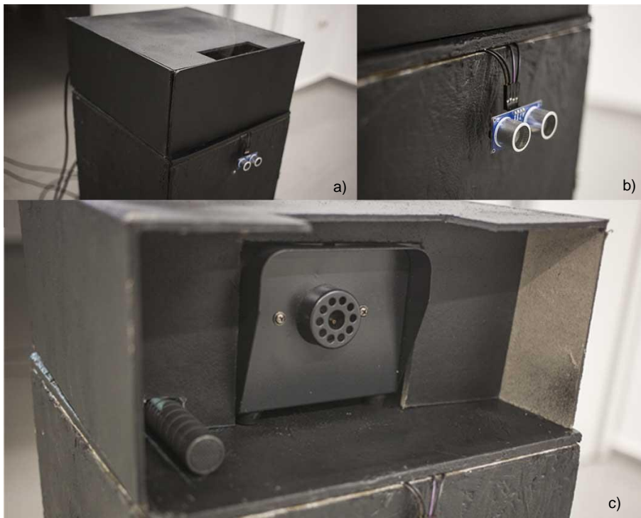
Fig. 50. Aspectos del montaje de la pieza: a) Peana y modulo principal; b) Detalle del sensor de ultrasonido; c) Interior del módulo, con máquina de humo y micrófono de condensador.
