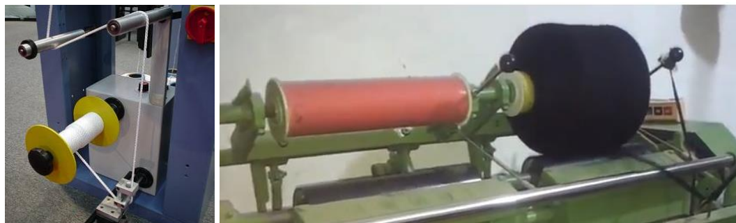
Figura 2.2. Unidad bobinadora de la maquina hiladora
