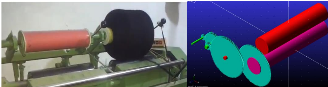
Figura 2.8 Esquema pictográfico de la bobinadora.
