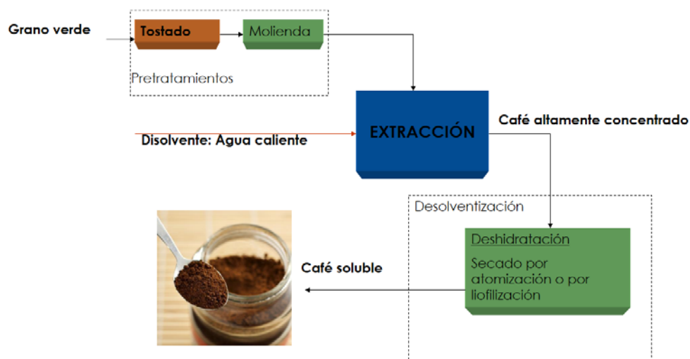
Figura 2. Proceso de obtención de café soluble
