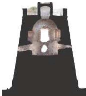
Fig. 5. Sección oeste-este del estado actual de la Torre de Lagos.
