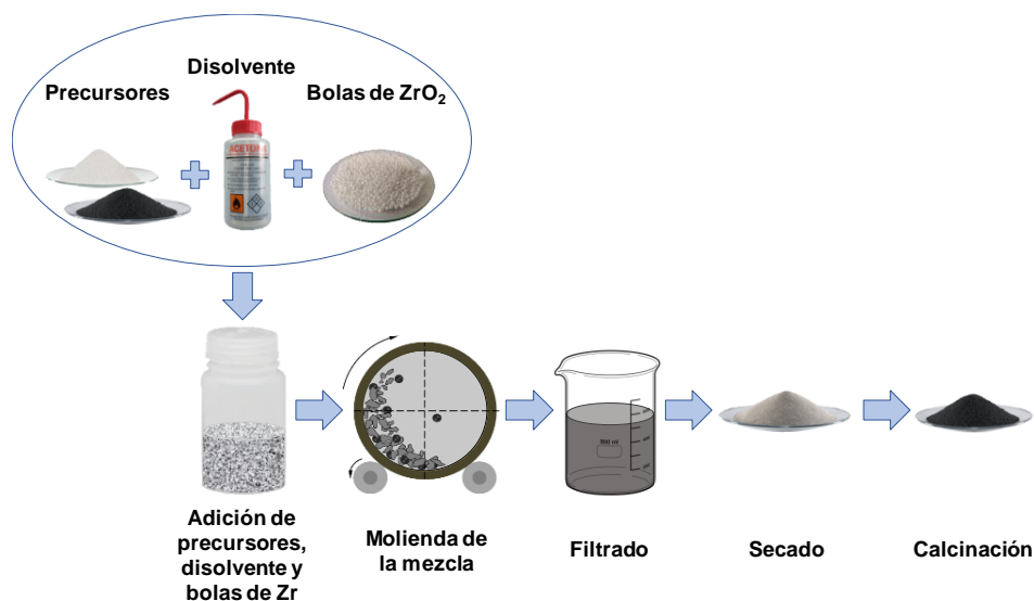
Figura 4.1. Esquema de la reacción en estado sólido para la formación de un multicomponente de fase pura.
