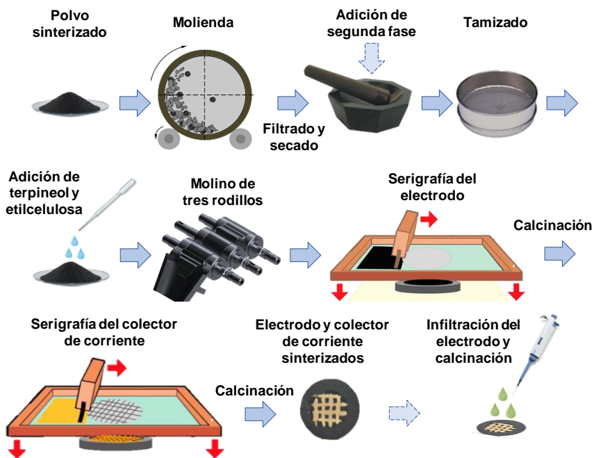
Figura 4.5. Metodología para la fabricación de electrodos porosos a alta temperatura.
