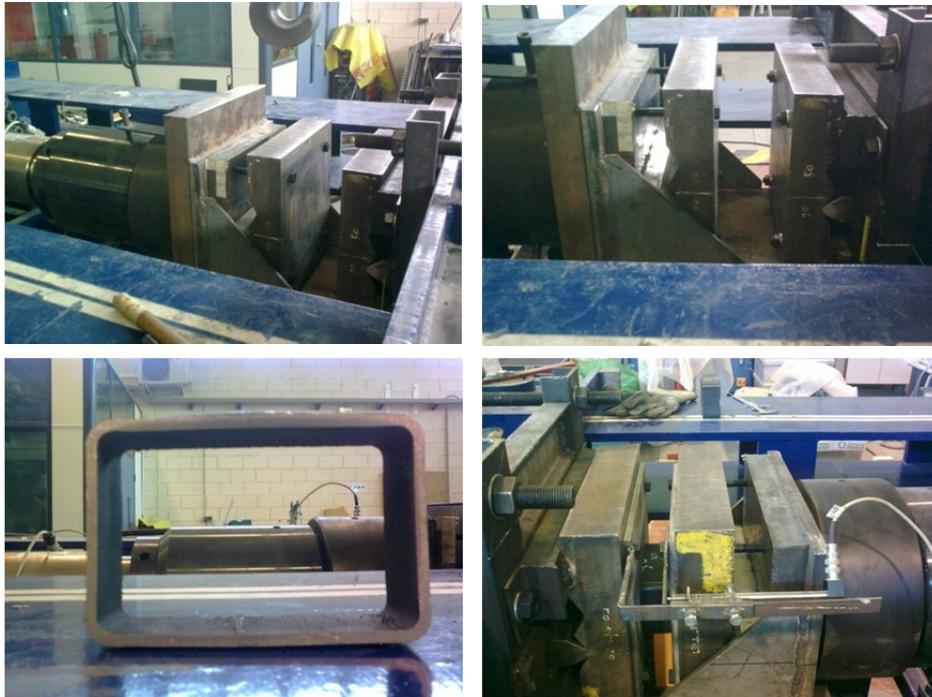
**Figura 4-21.** Configuración del pórtico horizontal para efectuar los ensayos sobre elementos compactos y caracterización del material del perfil vacío.
