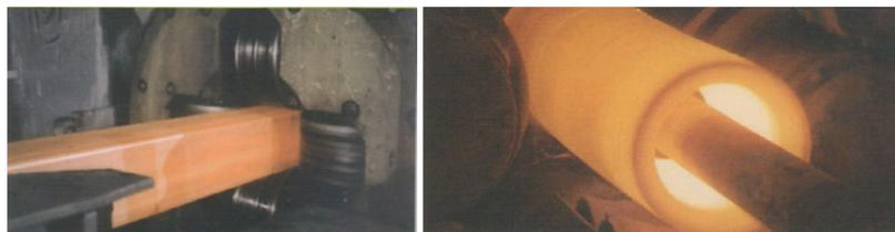
**Figura 2-12.** Proceso de conformado en caliente de perfiles tubulares. Construber[37].
