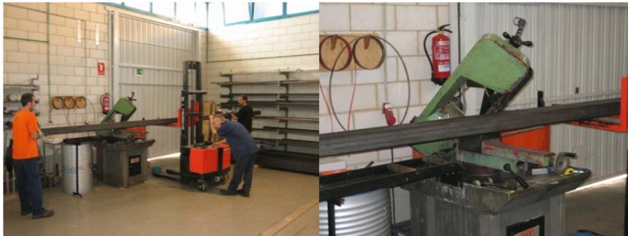
Figura 4-10. Proceso de corte de los tubos de 6 metros a las dimensiones requeridas.
