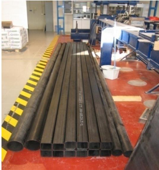
La construcción de los especímenes se realiza en el laboratorio de Estructuras y Construcción de la Universitat Jaume I de Castellón. Los perfiles tubulares de acero se comercializan en tubos de seis metros de longitud, y en particular, para esta campaña, se adquirieron
