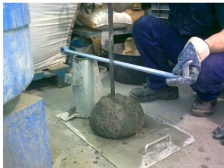
**Figura 4-4.** Ensayo del Cono de Abrams.
