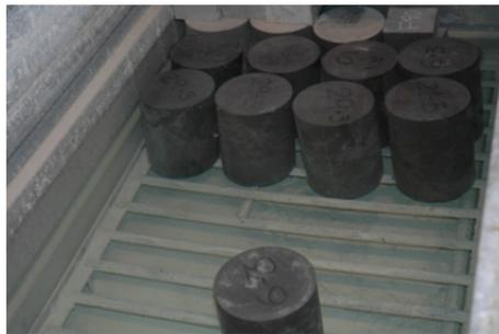
**Figura 4-5.** Conservación de las probetas en un tanque con agua saturada de cal.
