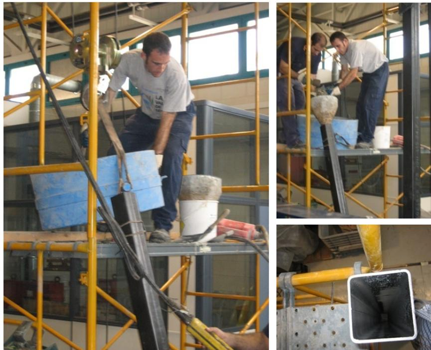
**Figura 4-11.** Proceso de fabricación de un pilar a ensayar. Fase de hormigonado.
