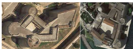
Fig. 11. I castelli di Otranto e Taranto in cui è visibile il rapporto tra rondelle e cortine murarie (Google Earth).
