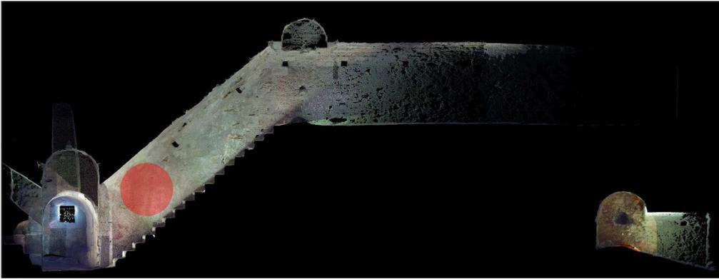
Fig. 13. Torre della Vedetta. Rilievo laser scanner 3D. In evidenza la sezione della scala che dal livello inferiore conduce ad uno dei livelli intermedi. In rosso l'area in cui è presente la grande nave incisa (Mitello, Muscatello, 2019).
