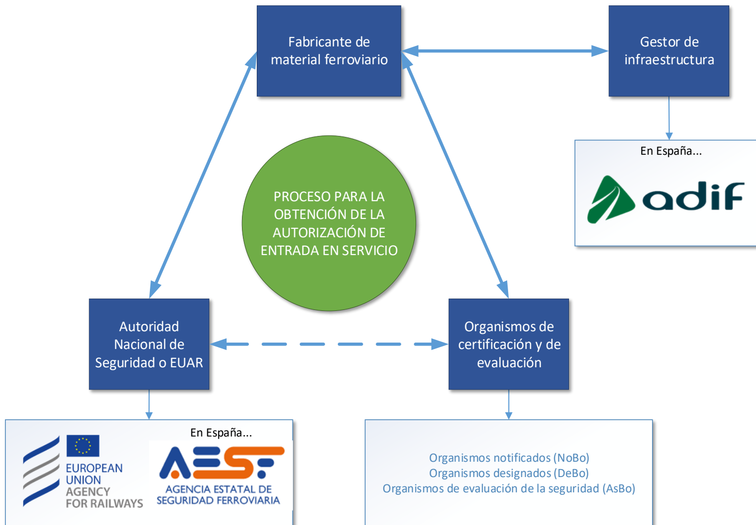
Figura 13 Representación esquemática de los distintos agentes y sus relaciones en el proceso de autorización de entrada en servicio de un vehículo. Fuente: Elaboración propia.
