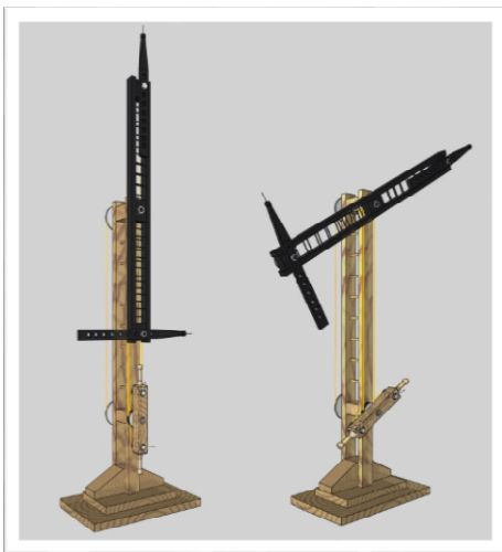
Fig. 4. 2019, Vincenzo Cirillo, Restituzione in 3D del modello del telegrafo Chappe (Marotta, Netti, 2019).
